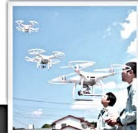
UAVによる 空中写真測量
